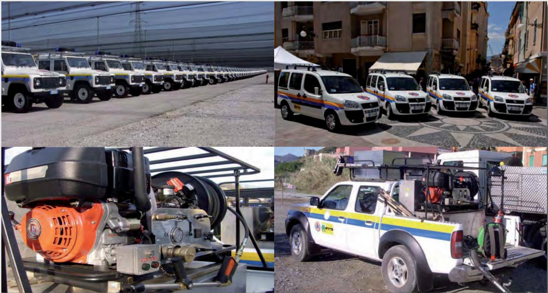
*Gli automezzi più idonei al territorio impervio della Liguria sono “pick-up” omologati per il trasporto di 5 persone e dotati di un modulo AIB (serbatoio per trasporto di acqua da 400/500 litri e motopompa ad alta pressione).*
