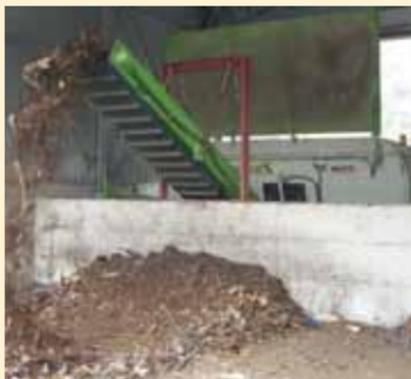
3. dopodiché il materiale viene disposto in cumuli e lasciato maturare. La maturazione si divide in due fasi: la prima, detta di **biossidazione accelerata**, dura circa un mese e si contraddistingue dal fatto che il materiale viene continuamente aerato mediante un impianto costituito da griglie e ventilatori. Una seconda fase, che dura circa due mesi, in cui il processo di degradazione biologica procede più lentamente fino ad assumere delle qualità di compost “pronto”.
